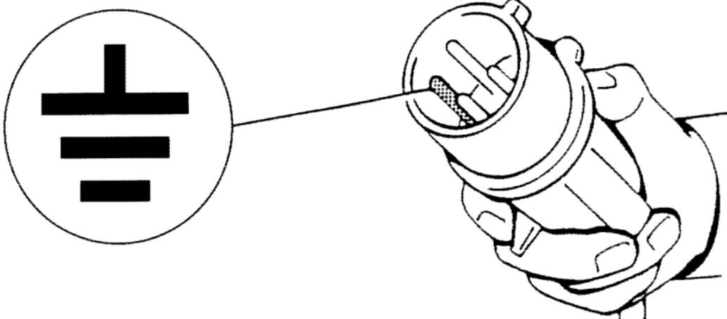
Перед тем, как подсоединить машину к электросети, убедитесь, что напряжение сети соответствует напряжению, указанному на табличке, расположенной на задней стенке машины, и что оборудование заземлено в соответствии с действующими правилами техники безопасности. Если напряжение в сети точно не известно, проконсультируйтесь со службой местной электростанции.
